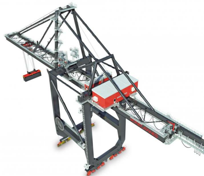
Portêiner utilizado no Terminal de Contêineres
