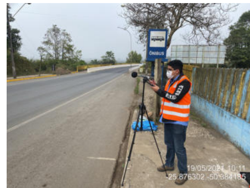
Medição diurna de ruído.
