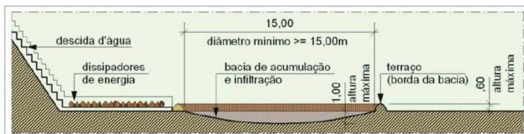
Figura 15. Fase 1 - Detalhes da descida d'água e da bacia de acumulação e infiltração
