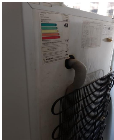
Figura 16: Refrigerador com a tabela de consumo/eficiência do INMETRO, indicando a Classe A.
