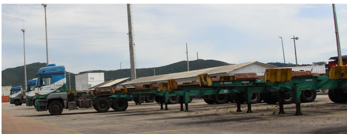
Figura 30: Semirreboques (unidade tratora acoplada ao chassi para transporte de contêiner).
