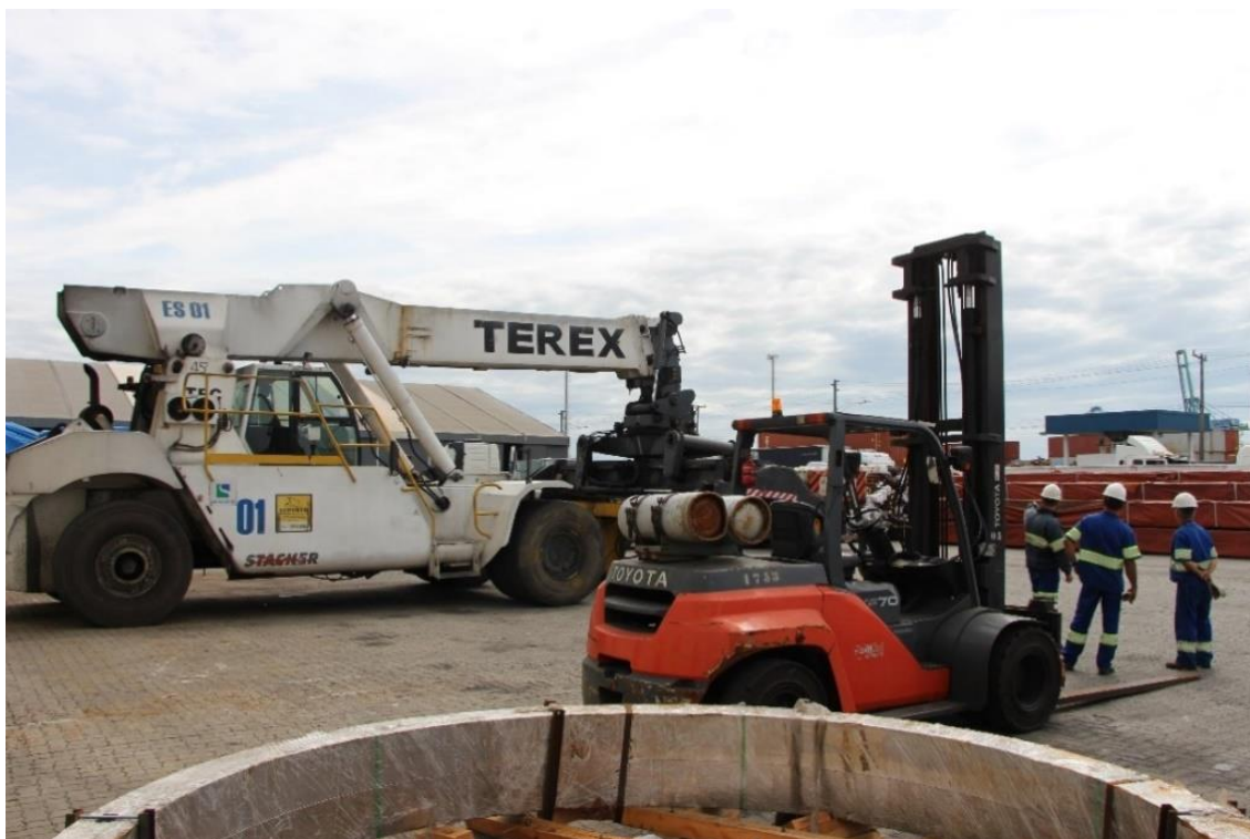
Figura 29: Reach Stacker (utilizado no transporte de contêineres) e empilhadeira pequena de garfo único (utilizada para transporte de carga geral).
