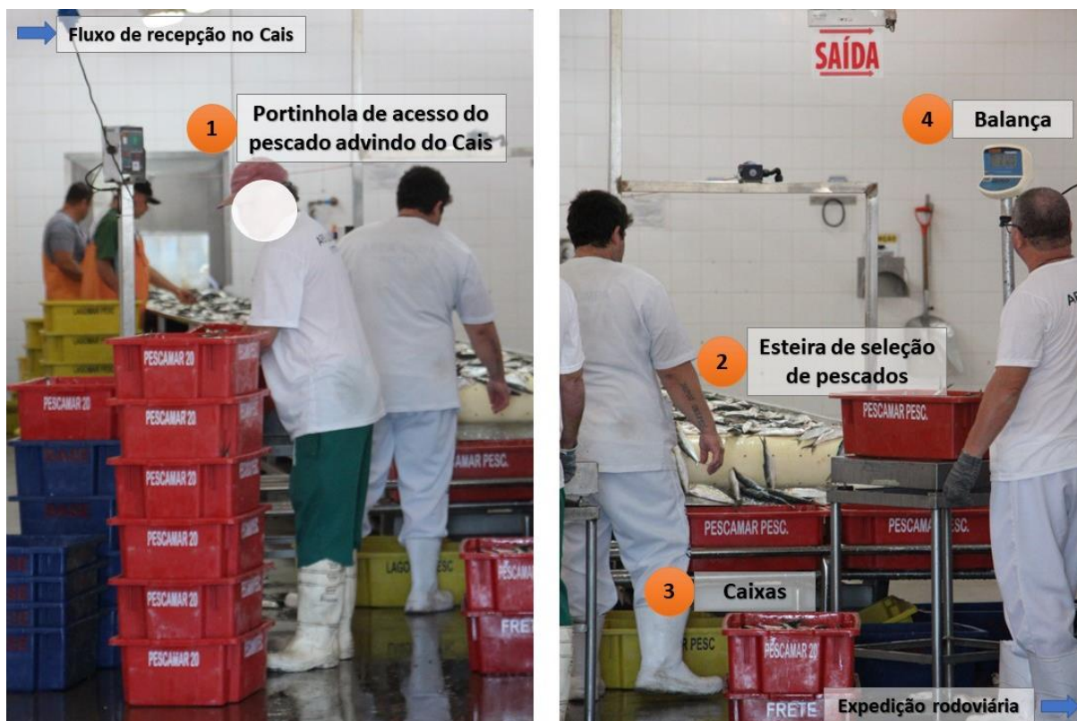
Figura 135: Fluxo do pescado no interior dos salões de recepção e uso dos equipamentos, em direção à expedição rodoviária.
