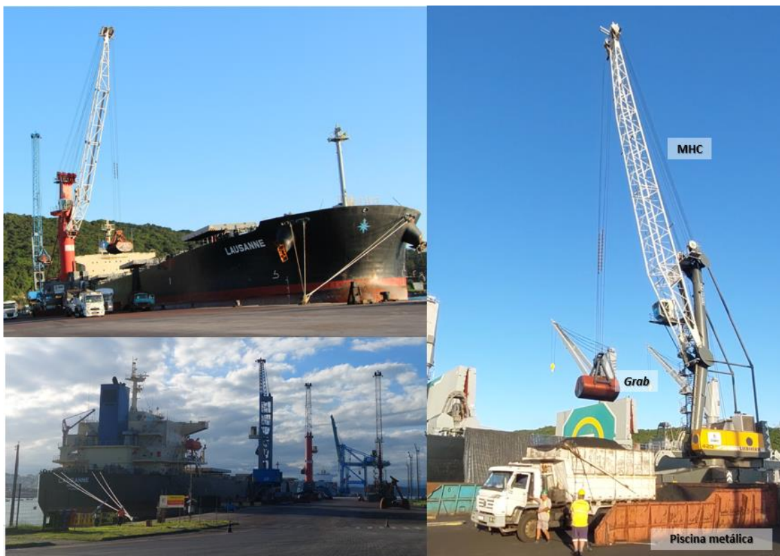
Figura 26: Equipamentos do tipo MHC em uso no Porto de Imbituba Fonte: Imagem obtida durante visita técnica da INFRA S.A. (2022).
