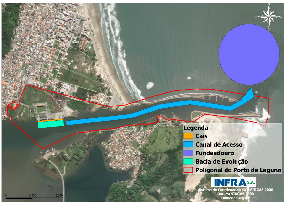
Figura 139: Canal de acesso do Porto de Laguna. Fonte: SCPAR (2022). Elaboração: INFRA S.A. (2023).
