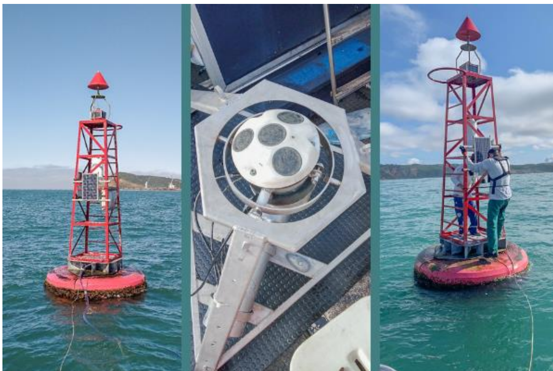
Figura 43: ADCP ( Acoustic Doppler Current Profiler ) do Porto de Imbituba. Fonte: SCPAR Porto de Imbituba (2022).
